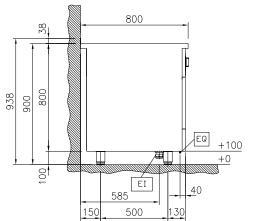
Electrical inlet (power) FΩ Equipotential screw
